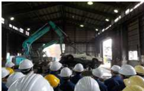
②マルチ解体機による 廃車の解体↓
