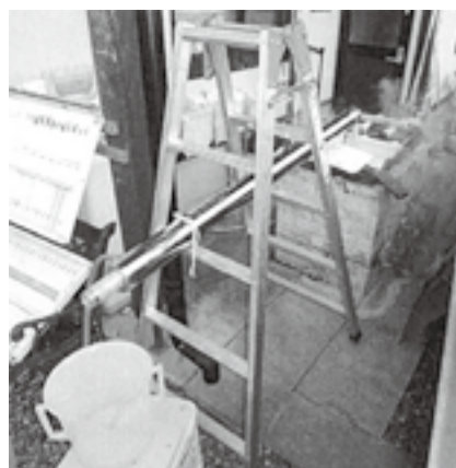
図3 考案した温泉蒸気の採取装置
